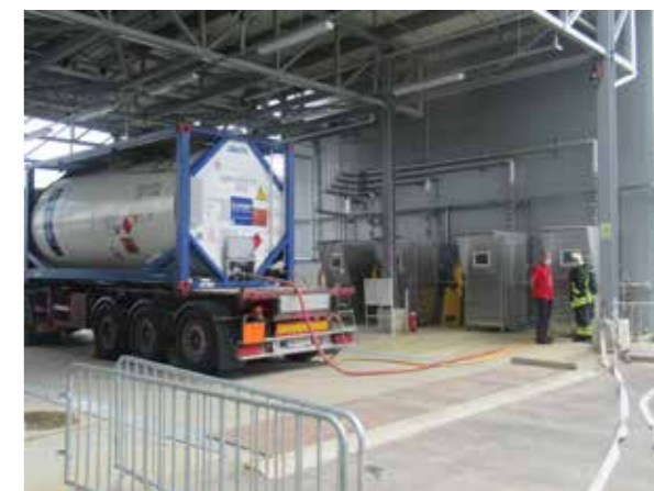
A technológiai zártsága miatt az emberi kontakt kizárható: a képen az elektrolit zárt rendszerű lefejtése látható.
